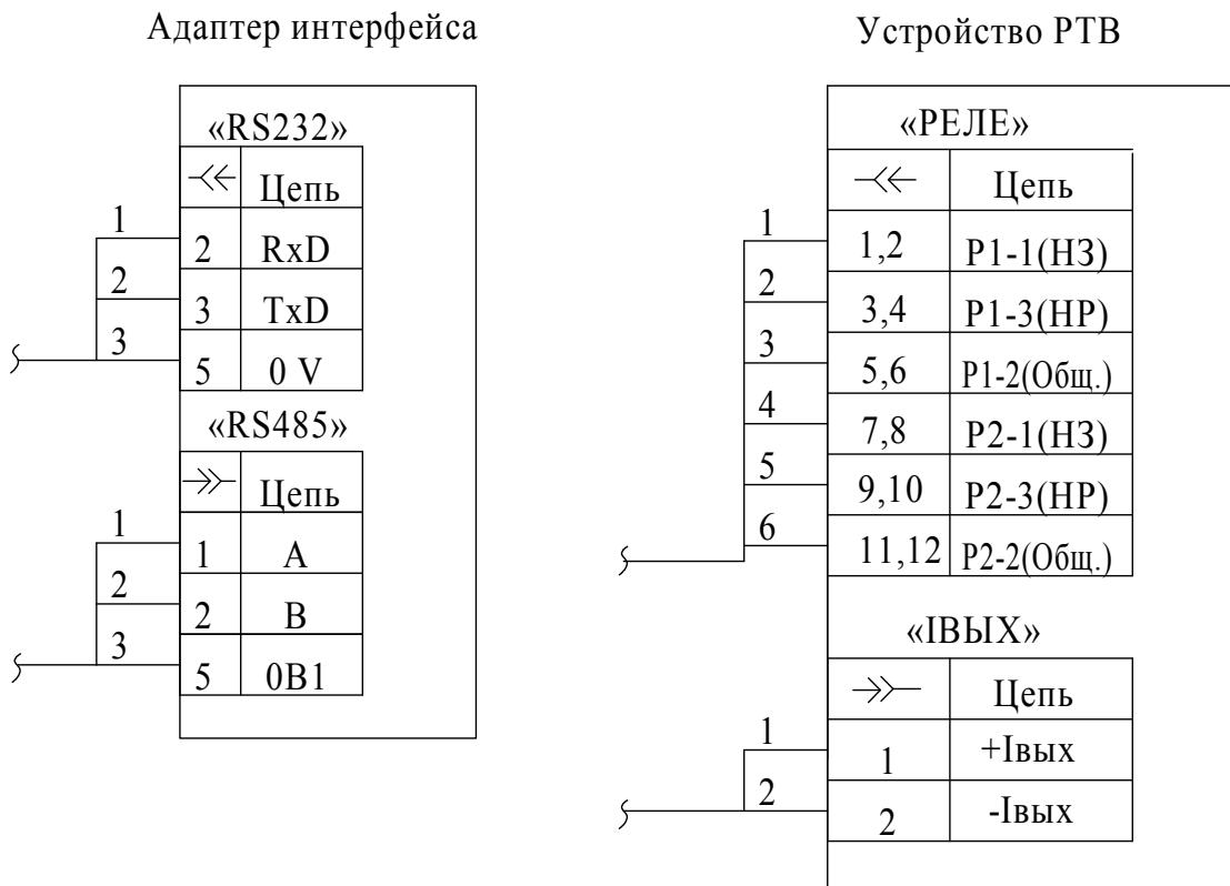
Рисунок 2.1 – Схема распайки разъемов устройства PTB и адаптера интерфейса.
